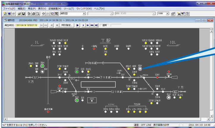
再生・モニタ時には、線形図上の表示灯を模した白丸が実物と同様の色で点灯します。
